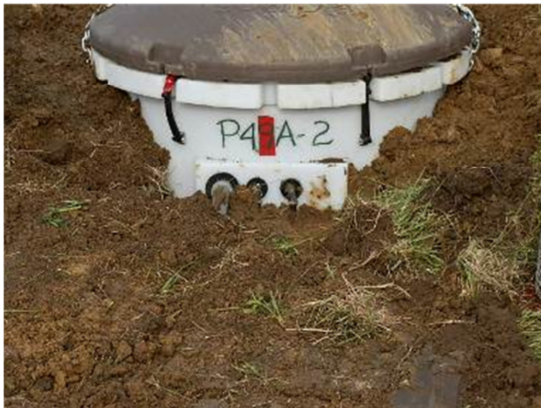
Electrical conduit Infrasond port pump exhaust
